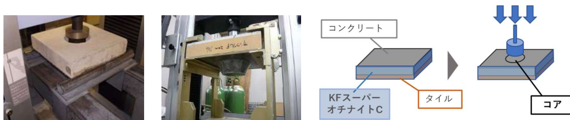
コンクリート押し抜き試験イメージ
